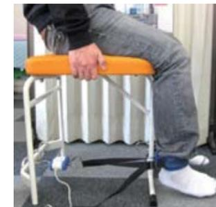
股関節屈筋筋力測定器
